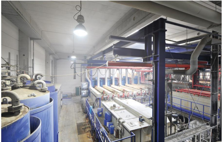
Abb. 2: Periodisch auftretende hohe Dampf- und Nebelkonzentrationen sind charakteristisch für den Galvanisierungsbetrieb
