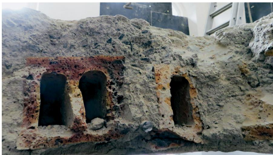
Abb. 2: Da ein Teil der Stahlsteindecke für den Bau eines Treppenraums abgebrochen werden musste, standen ausreichend Proben für Untersuchungen zur Verfügung.
