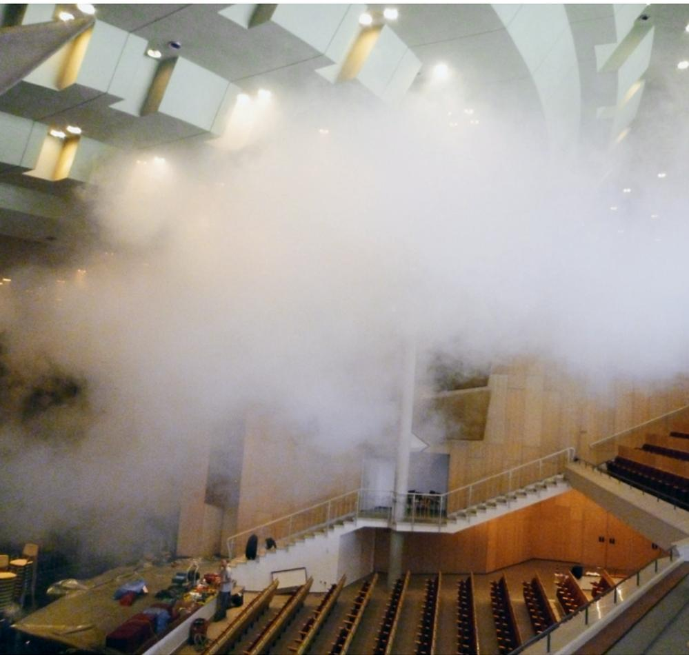
Abb. 4: Durchgeführter Rauchversuch im Zuschauerraum
